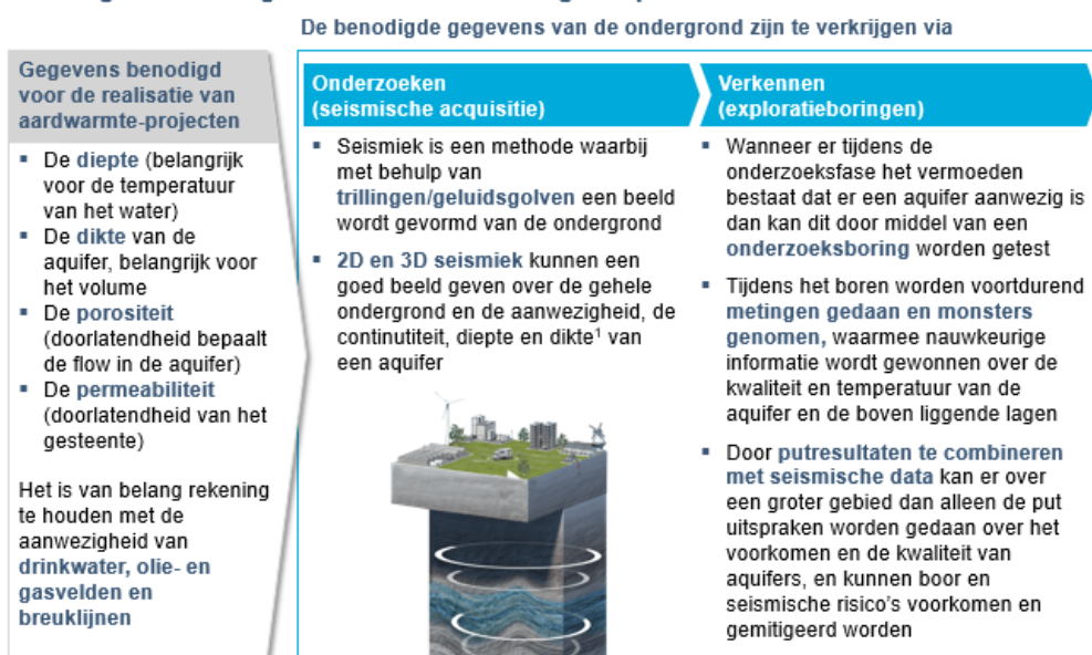
Figuur 12: Via seismische acquisitie en exploratieboringen wordt de nodige kennis van de gehele ondergrond steeds nauwkeuriger bepaald
